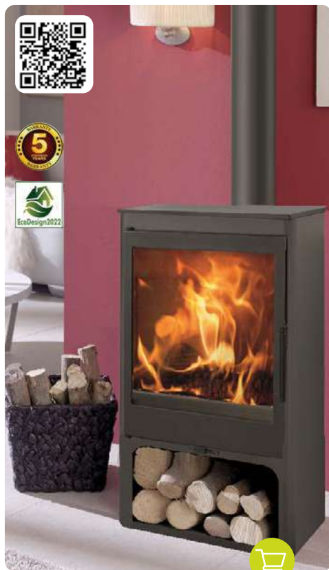
KNYSNA 134423 5,9 kw. Rendimiento: 77%. 712 x 436 x 443 mm. Parrilla y puerta de hierro fundido. Leñero y doble cuerpo en chapa 3+3 mm. Triple combustión. Volumen de calefacción: 180 m 3 . Emisión de CO: 0,10%.
